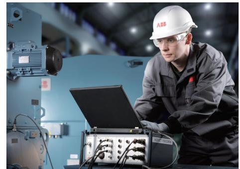
ABB MACHsense-R 是一个针对电动机和发电机的远程状态监控解决方案，连续远程监控可以在电动机和发电机生产运行中起到至关重要的作用，比如水泥厂的干燥炉或者那些轻易无法接近的设备，比如海事或者采矿等行业的电机。
